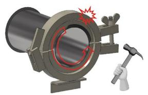
Längere Rohre sind während des Bördelprozesses zu unterstützen. Die Bördelvorrichtung ist für die Umformung von Rohrenden aus Stahl bis maximal 2 mm Materialdicke geeignet. Bei einer Materialdicke ab 3 mm sollten Anschweißenden zur Rohrverbindung eingesetzt werden.
